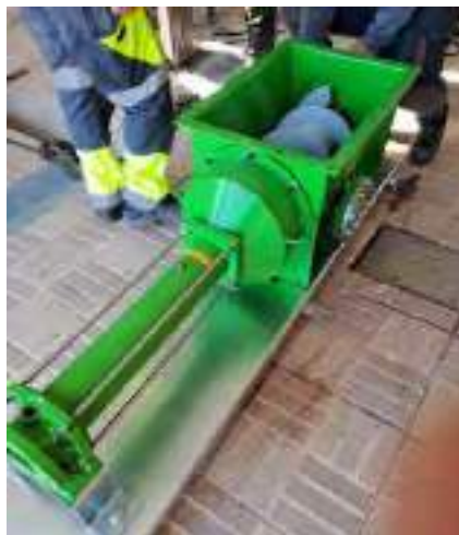
Bomba d'elevació de fangs de Santa Coloma
