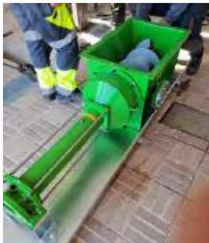
Bomba d'elevació de fangs de Santa Coloma
